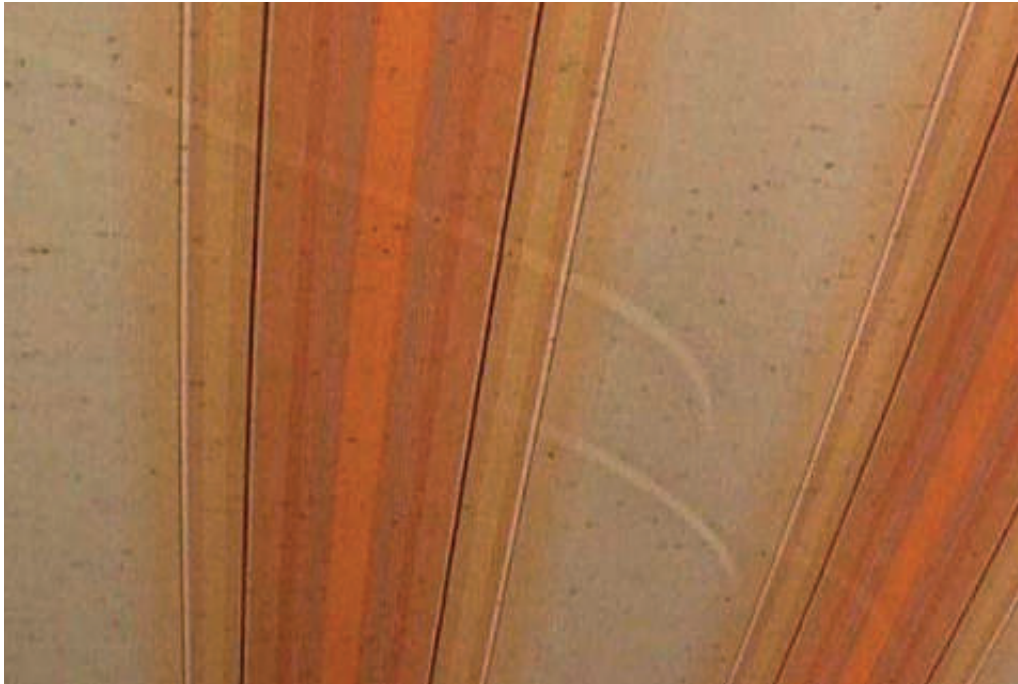
Bild 9.1.13 Darstellung von Überlagerung von Wickelfalten
